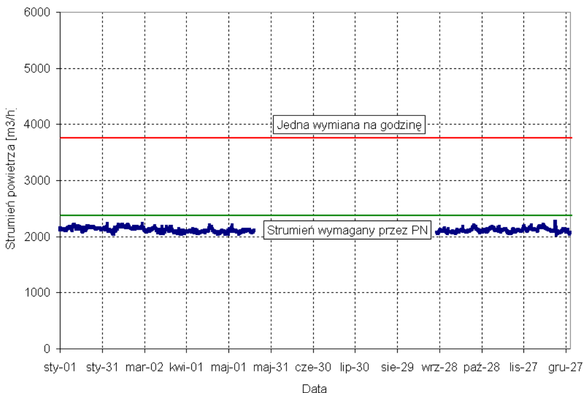
Rys. 49. Przebieg zmienności strumienia powietrza dla mieszkań.
