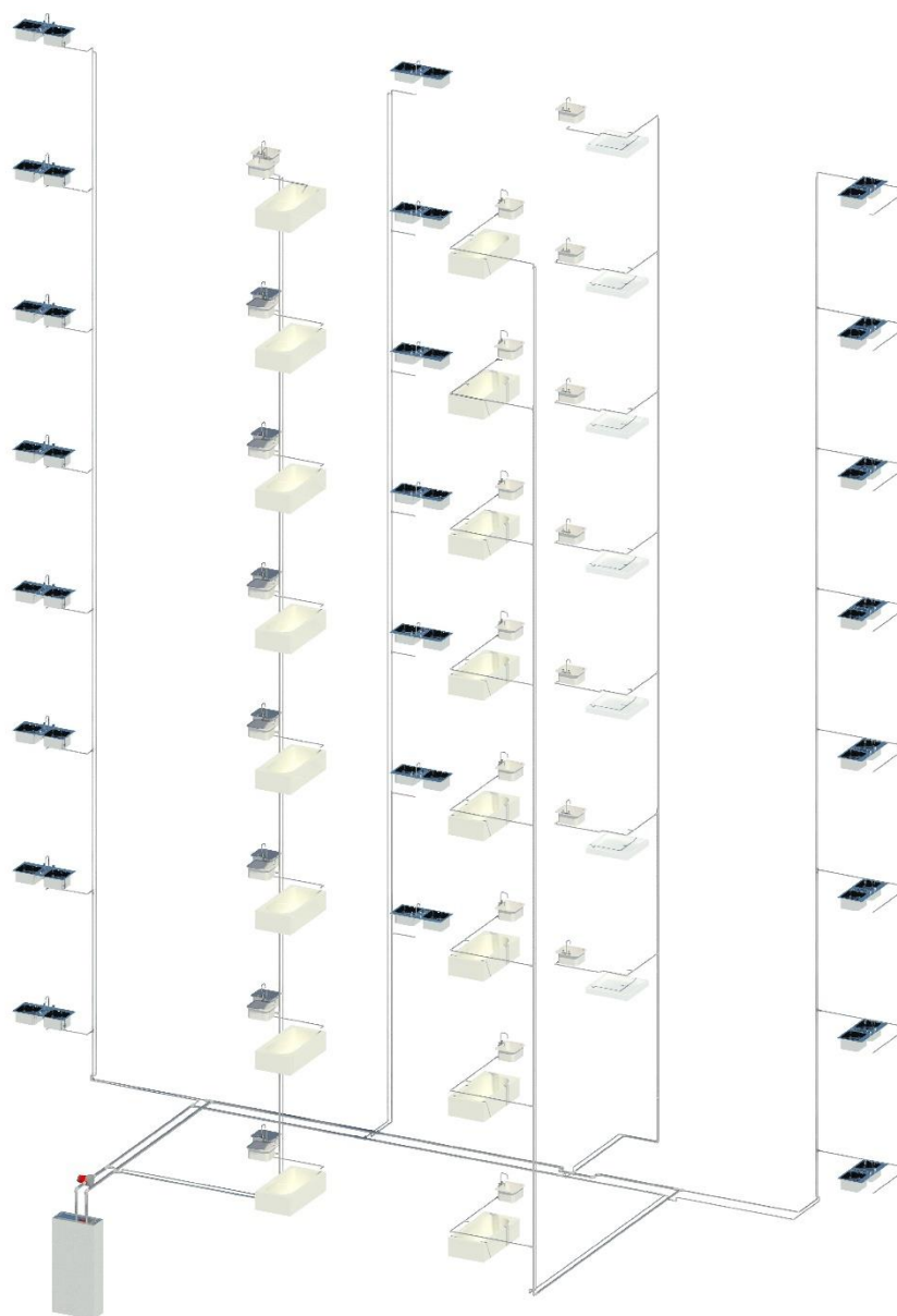
Rys. 21. Aksonometria instalacji c.w.u. i instalacji cyrkulacyjnej.
