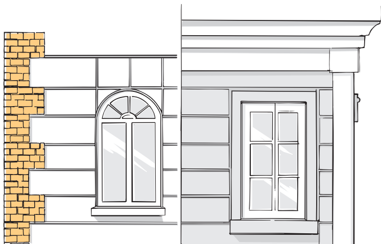
Rys. 2. Elewacja z użyciem profili elewacyjnych.
