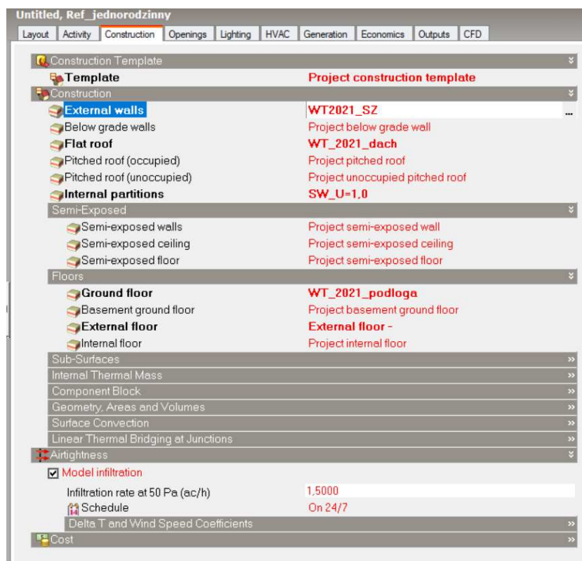
Rys. 50. Zakładka Construction do wprowadzenia danych dotyczących przegród budynku jednorodzinny NAPE w programie DesignBuilder
