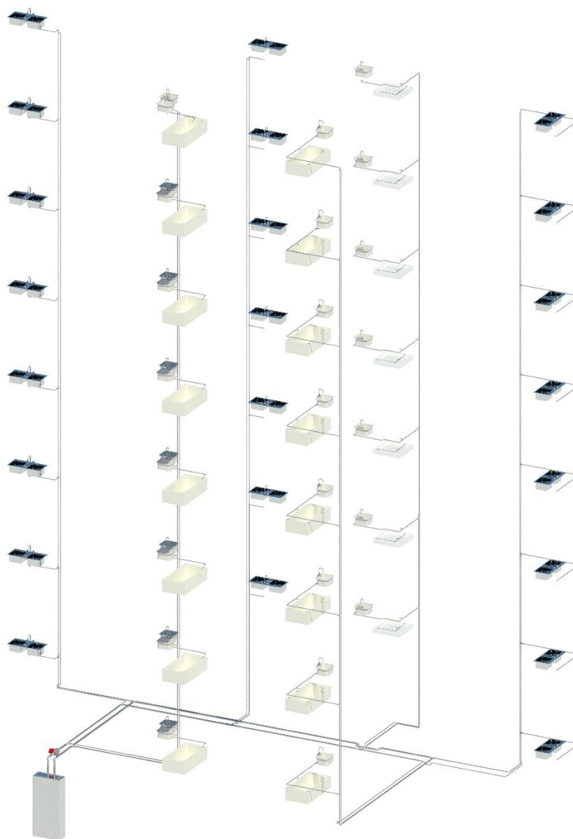
Rys. 12. Aksonometria instalacji c.w.u. i instalacji cyrkulacyjnej
